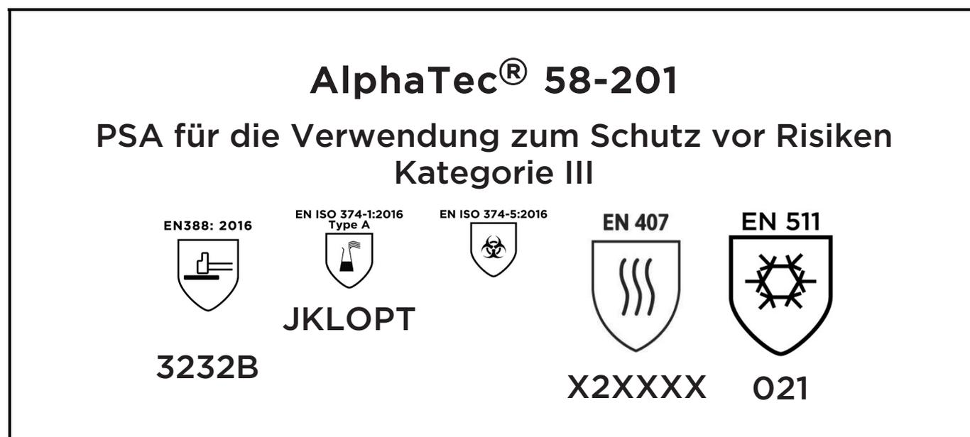
erfüllt die Vorschriften der Verordnung (EU) 2016/425 und der Normen EN 388:2016 +A1:2018, EN ISO 374-1:2016, EN ISO 374-5:2016, EN407:2020 , EN 511 Kälteschutz und ist identisch mit der PSA, die der EU-Baumusterprüfung (Modul B, Anhang V der Verordnung) unterliegt; die von der benannten Stelle zugewiesene Zulassungsnummer 032/2022/0792 lautet:
