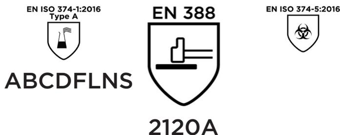
erfüllt die Vorschriften der Verordnung (EU) 2016/425 und der harmonisierten Europäischen Normen EN ISO 374-1:2016, EN 388:2016, EN 420:2003 + A1:2009, EN ISO 374-5:2016 und ist identisch mit der PSA, die der EU-Baumusterprüfung (Modul B, Anhang V der Verordnung) unterliegt; die von der benannten Stelle zugewiesene Zulassungsnummer 032/2018/0535.03 lautet:
